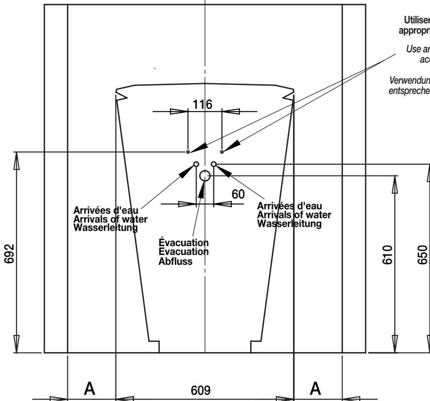
Utiliser des chevilles et des vis appropriées pour fixation au mur.
